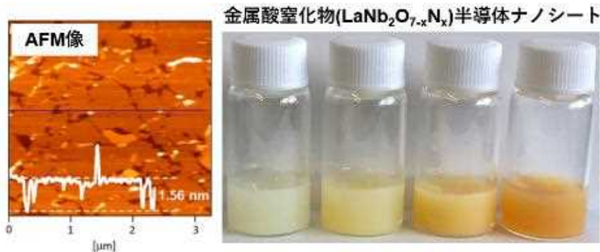
図2. 酸窒化物ナノシートの原子間力顕微鏡 (AFM) 像とナノシート分散溶液の写真
